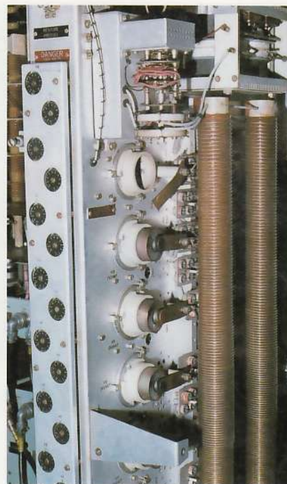
Details 1 kiloWatt zender, de eindtrap met 16 buizen..
